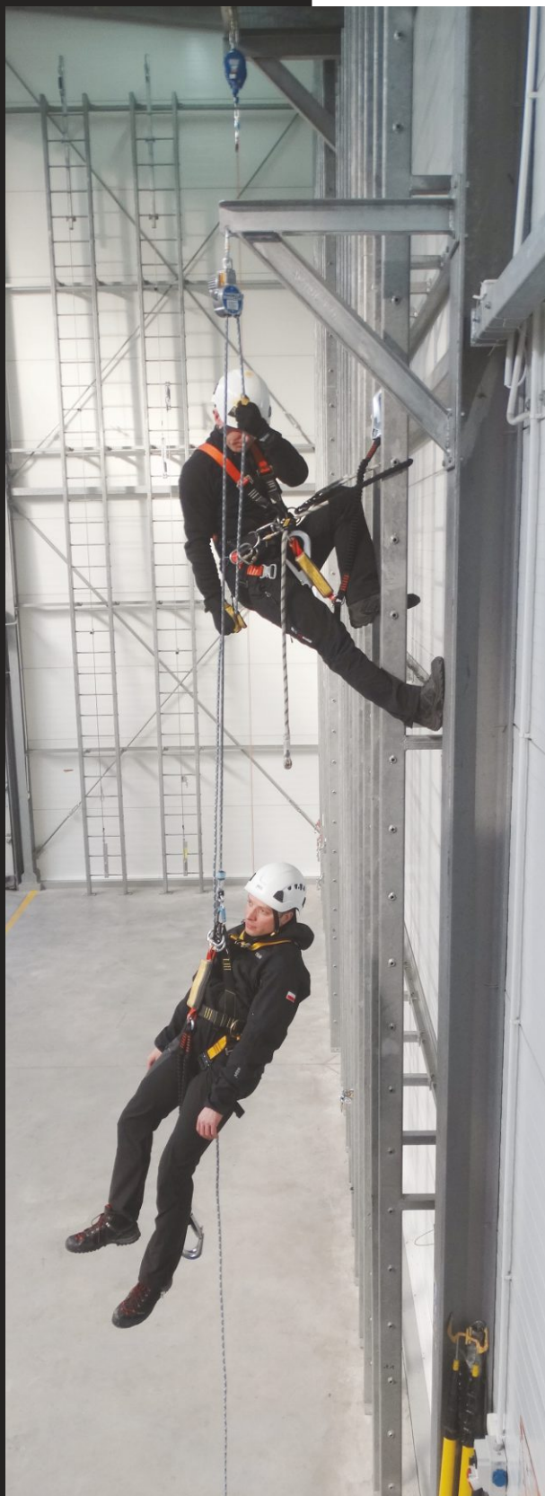
Opuszczanie za pomocą urządzenia AUTOEWAK: szelki, zaczep taśmowy i urządzenie do automatycznej ewakuacji.
